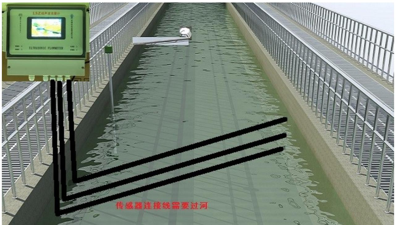
单主机河道测量示意图(需要传感器电缆过河)
