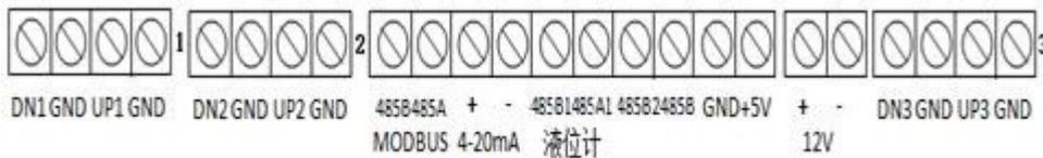
UP、DN : 3 个传感器上下游接线, 接线时上下游顺序一致, 上下游屏蔽线绞在一起接入 GND
